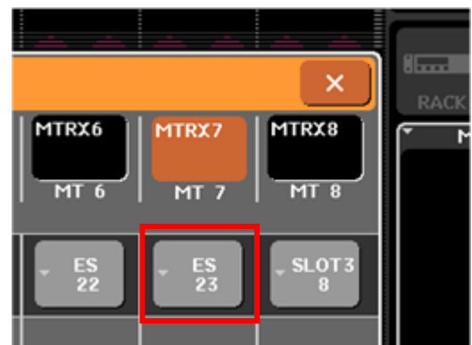
SB168-ES ID#3のOutput 7をSt LからMatrix7に変更した例 (Matrix 7をES23にパッチ)
